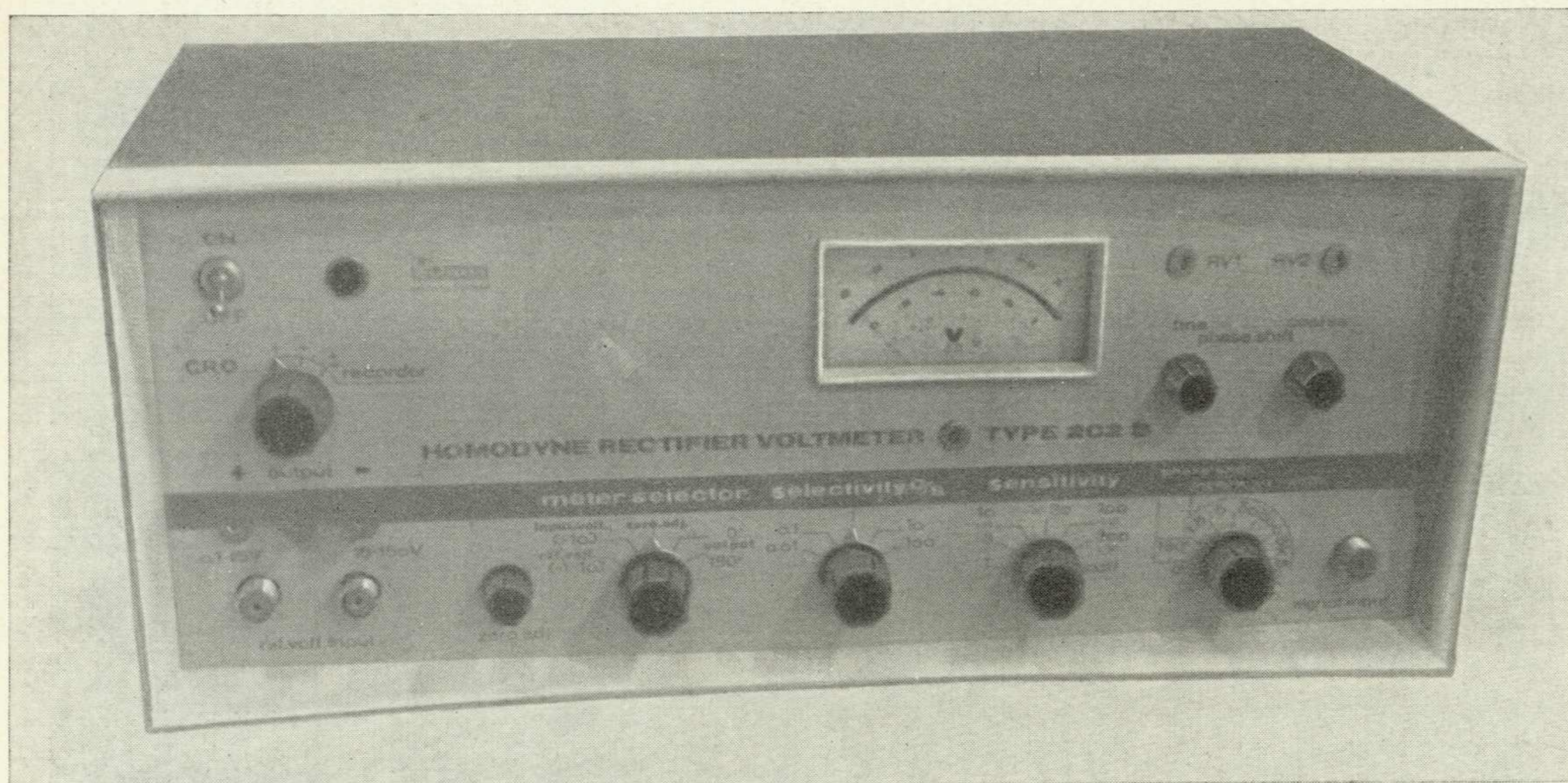
1. Селективный вольтметр звуковых частот типа 202 В. Автор М. Стжелецки, сотрудник конструкторского бюро экспериментального завода научной аппаратуры «Унипан». Фото 1—7 В. Быкова.
