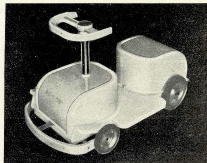
Детский автомобиль. Фирма *Кодама Кемикал*. Двигатель автомобиля работает от аккумуляторной батареи. Корпус сменный, выполнен из смол АВС.
