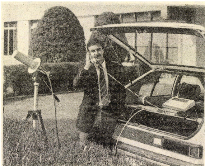
Рис. 5. Переносной оконечный аппарат подвижной системы спутниковой связи
