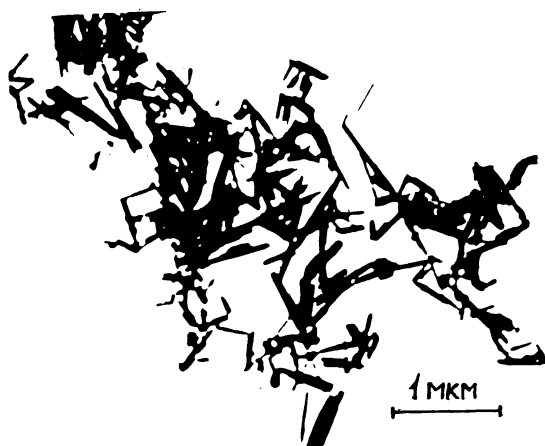
Рис. 3. Игольчатые частицы магнитного порошка
