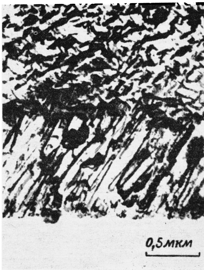
Рис. 3. Столбчатая структура кристаллитов металла, получаемая при наклонном нанесении
