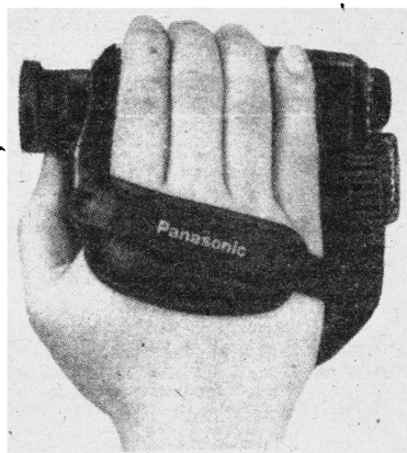
Рис. 9. Ручная видеокамера NV-S1E массой 780 г.
