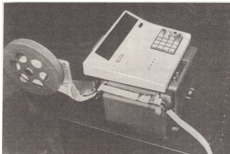
Рис. 1. Электронно-вычислительное устройство автономного управления перфоратором
