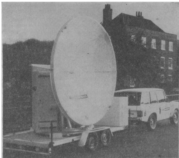
Рис. 6. Возимая земная станция фирмы GEC-McMichael, предназначенная для проведения спортивных ретрансляций и передачи новостей. Время разворачивания меньше 30 мин
