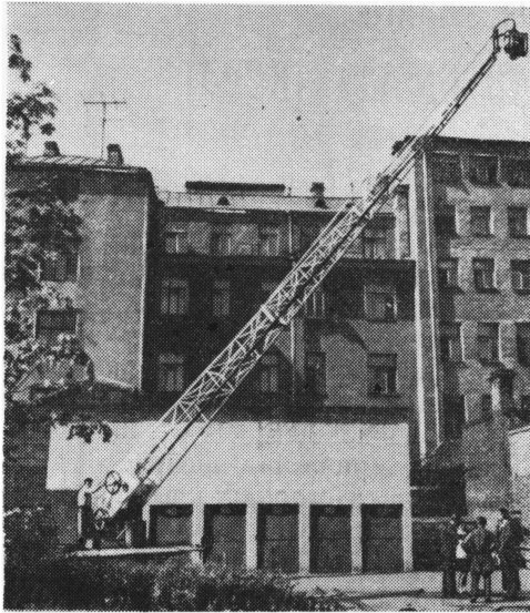
Рис. 10. Кран с аппаратурой дистанционного управления киносъёмочной камерой
