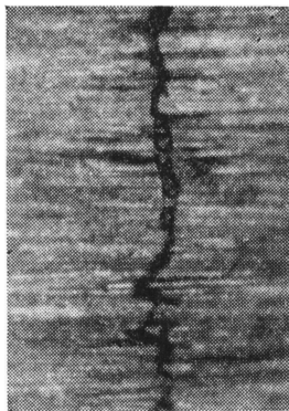
Рис. 3. Непараллельность стенок зазора, кривизна, волнистость
