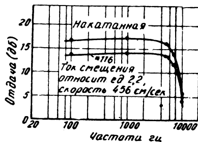
Рис. 16. Частотная характеристика «накатанной» ленты с магнитным слоем и ленты «Скотч-116»
