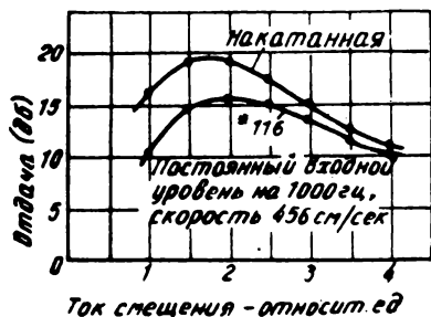
Рис. 15. Чувствительность ленты с «накатанным» магнитным слоем в сравнении с лентой «Скотч-116»
