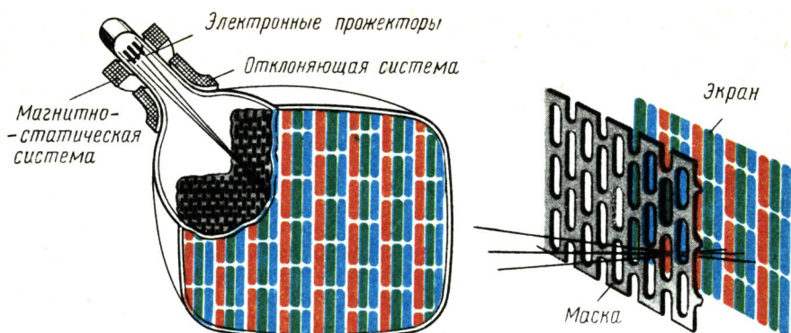
Рис. 3.16. Устройство кинескопа с самосведением
