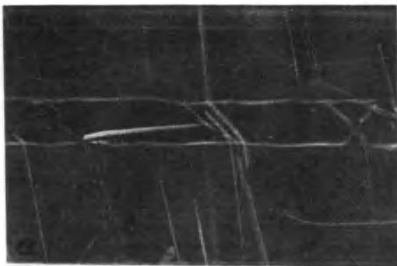
Рис. 1. Топограммы монокристалла кварца, полученные методом Ланга. Рефлекс (1011). Режим рентгеновской трубки БСВ-19Мо: U_a = 40 кВ, I_a = 40 мА; а — полученная на рентгеночувствительной пленке, время экспозиции 60 мин; б — полученная на экране ВКУ установки визуализации рентгенотопографических картин ТУР-1 при помощи описанного рентгеновидикона. Время формирования изображения 2 мин
